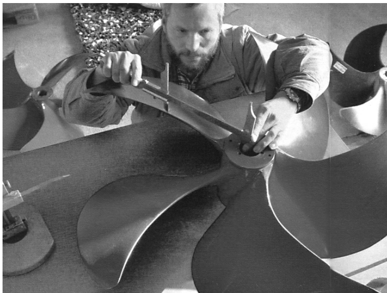
Эта лопасть судового винта выполнена из углеродного волокна
